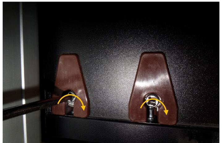
Seitenblende rechts und links die die Befestigungsbolzen einsetzen und diese fixieren.
