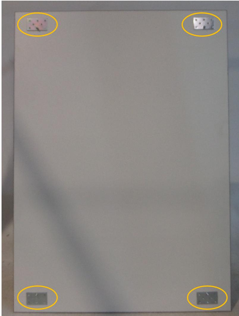
Jeweils 4 Montageplatten auf allen Flügeln (4 Stück) in den vorgekörnten Bohrungen festschrauben
