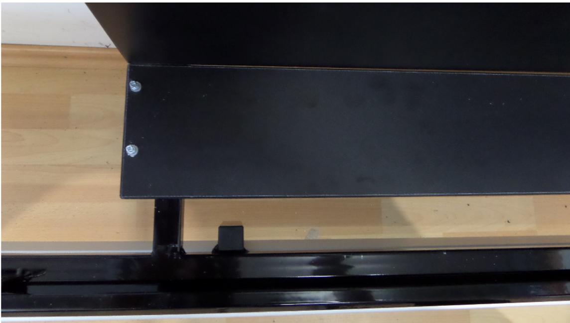
Blende auf die Unter- und Oberstange legen und bündig an das Passepartout schieben. Unter- und Oberstange an Blende ranschieben
