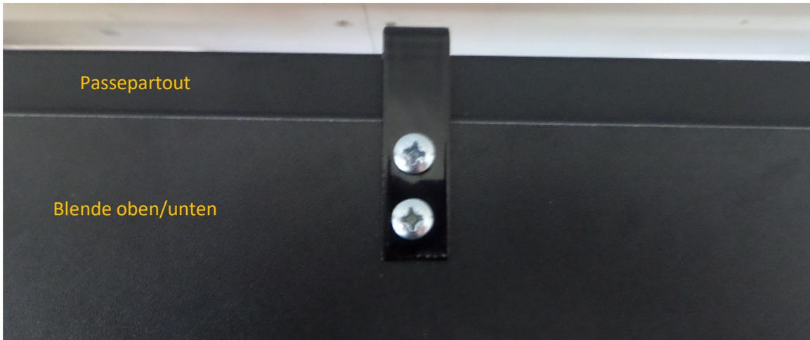
Winkel mittels Klebeband am Passpartout mittig positionieren und mit jeweils 2 Holzschrauben 5x17 an der oberen und unteren Blende fixieren.
